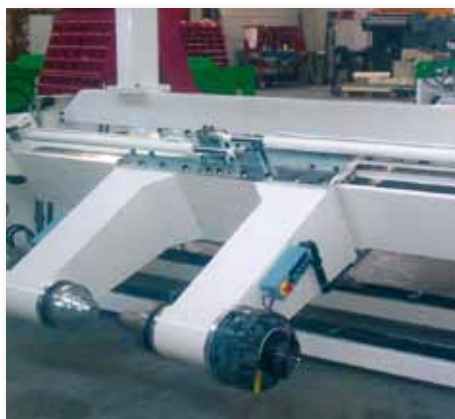
Тормоз Modulo 254 на машине для производства многослойного материала. Brake Modulo 254 on coating machine.
