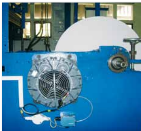
Тормоз Modulo 254 на машине для производства многослойного материала. Brake Modulo 254 on coating machine.
